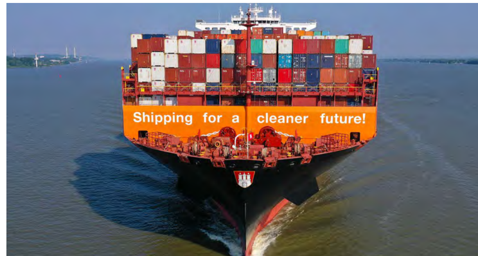
Die unter deutscher Flagge fahrende »Brussels Express« ist 2021 als erstes Großcontainerschiff weltweit auf umweltfreundlichen Gasantrieb (LNG) umgerüstet worden
