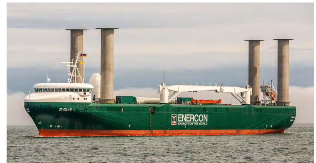
Dank des Flettner-Zusatzantriebes spart das 2010 in Dienst gestellte und unter deutscher Flagge fahrende Frachtschiff »E-Ship 1« bis zu 25% Treibstoff ein
